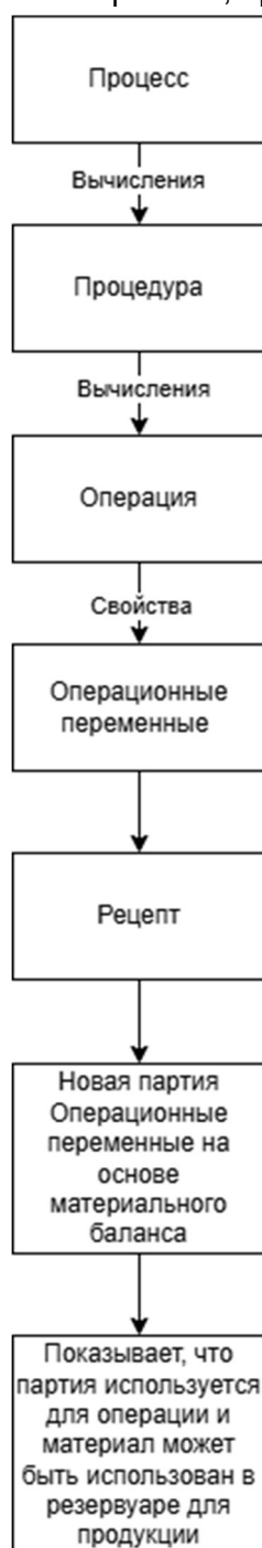
Рисунок 7.5.6- 1. Расчет материала резервуара
